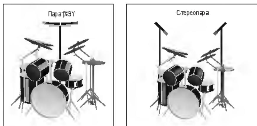
Рис. 8.17. Через общие верхние микрофоны записываются и барабаны, и тарелки
